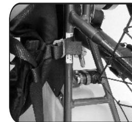
Fixação em duas fitas, uma aproxima o assento junto ao chassi e a outra que é proveniente dos ombros ajuda na sustentação e divisão do peso do motor.
