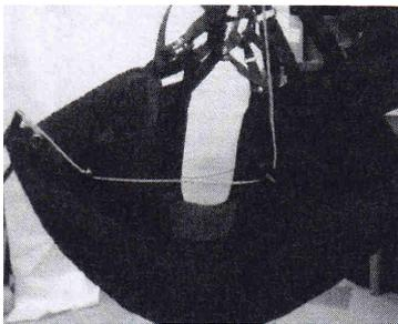
Beschleunigersystem innerhalb des Gurtzeuges
